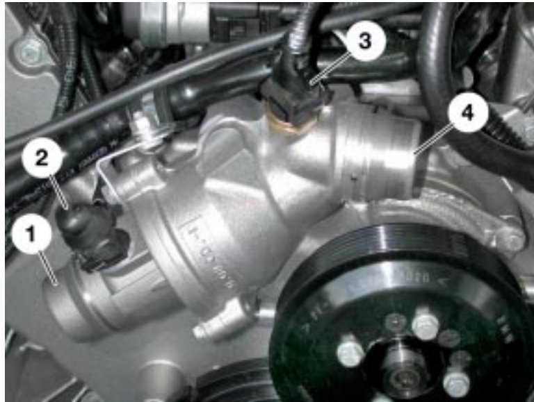
Abb. 46: Wasserpumpe mit Kennfeld-Thermostat
