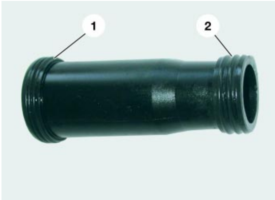
Abb. 20: Kunststoffhülsen für die Durchführung der Stabzündspulen durch die Zylinderkopfhaube zu den Zündkerzen.
