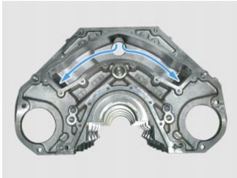
Abb. 41: Kühlmittelverlauf im hinteren Bereich des Motorblocks
